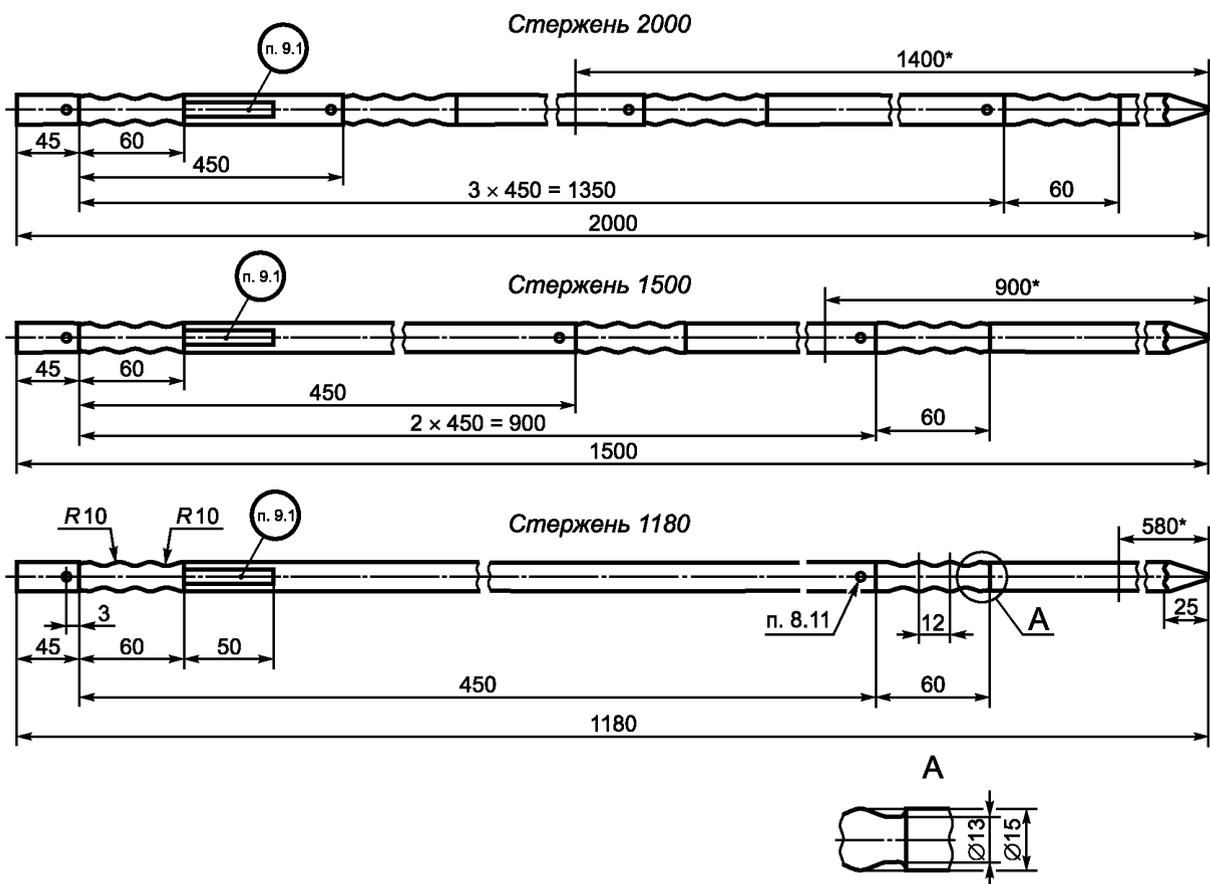
\* Глубина забивки стержня в грунт — справочная.
